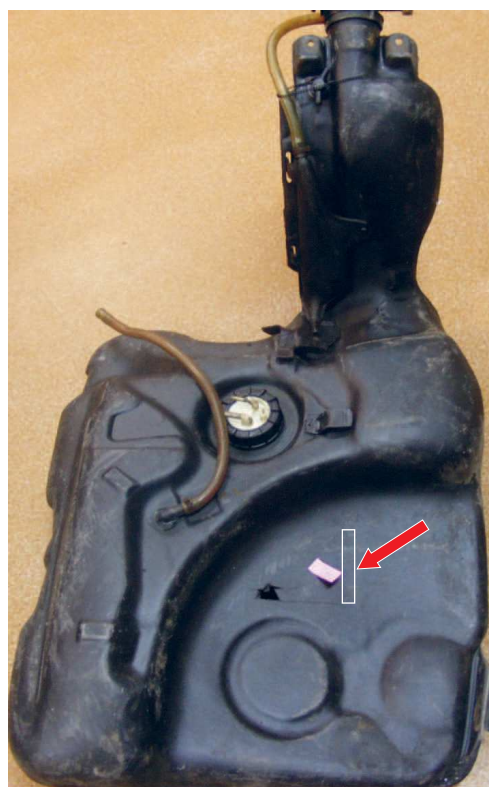
Rys. 3. Widok zbiornika z zaznaczonym miejscem i kierunkiem pobierania próbki.
