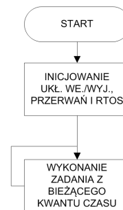
Rys. 5. Sieć działań programu realizującego pętlę główną Fig. 5. Block-diagram of the program realizing the main loop
