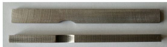
Fig. 9. Wycinek przekroju poprzecznego odkuwki kołpaka z zaznaczonym kierunkiem pobierania próbek oraz widok próbek do badań
