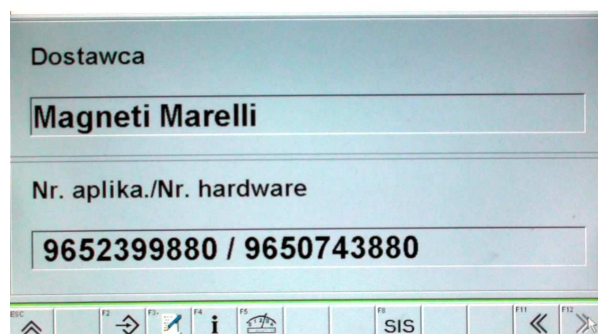
Rys. 4. Wybrane ekrany komunikatów testera KTS 670: identyfikacja sterownika (z lewej), wykryte usterki (z prawej)
