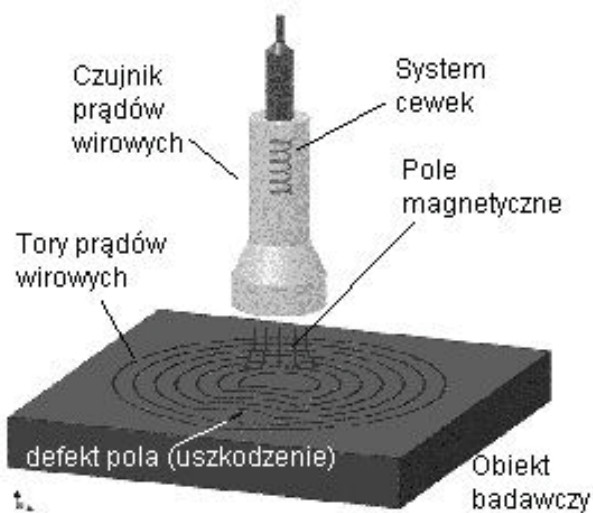
Rys. 1. Zasada pomiaru prądów wirowych [6]
