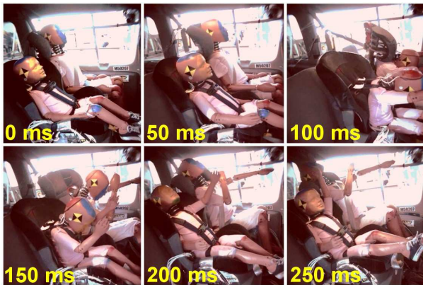
Rys. 6. Przesunięcia manekinów podczas zderzenia w teście V1; opracowano na podstawie [32]
