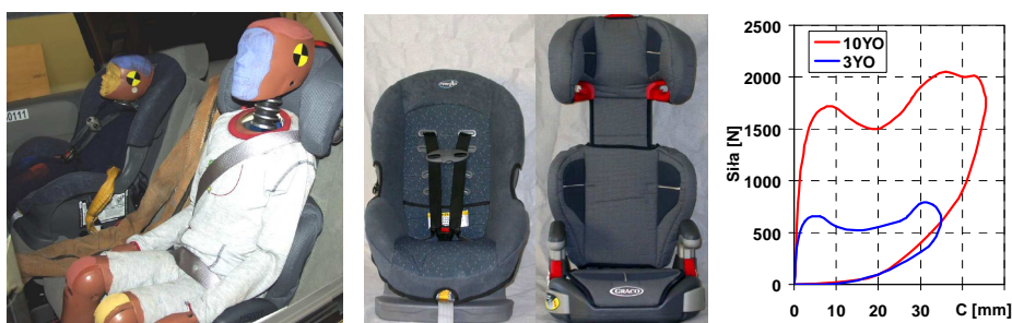
Rys. 4. Foteliki zabezpieczające manekiny podczas testów zderzeniowych oraz charakterystyka dynamicznego uginania klatki piersiowej [15, 16]
