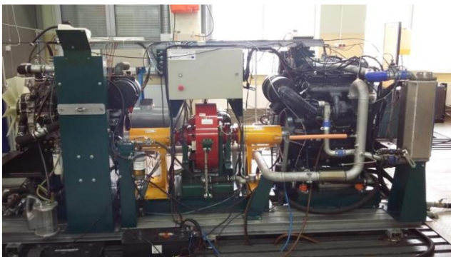
Rys. 1. Stanowisko hamowniane z silnikami Perkins: 1104D-E44TA i 1104D-44TA
