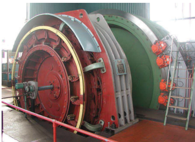
Rys.9. Maszyna wyciągowa z hydraulicznym hamulcem tarczowym [9]
