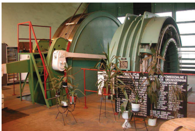
Rys.8. Maszyna wyciągowa z hamulcem szczękowym i napędem pneumatyczno-obciążnikowym [9]
