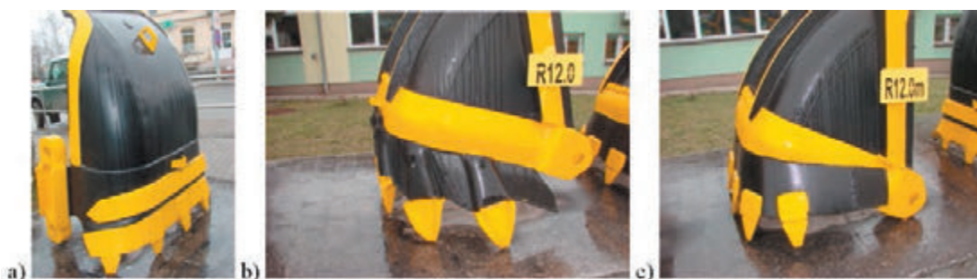
Rys. 3. Podstawowe typy czerpaków stosowane w KWB Turów a) Rs 560, b) R12 0 z zębami wymiennymi WKL, c) R12.0M z zębami stałymi
