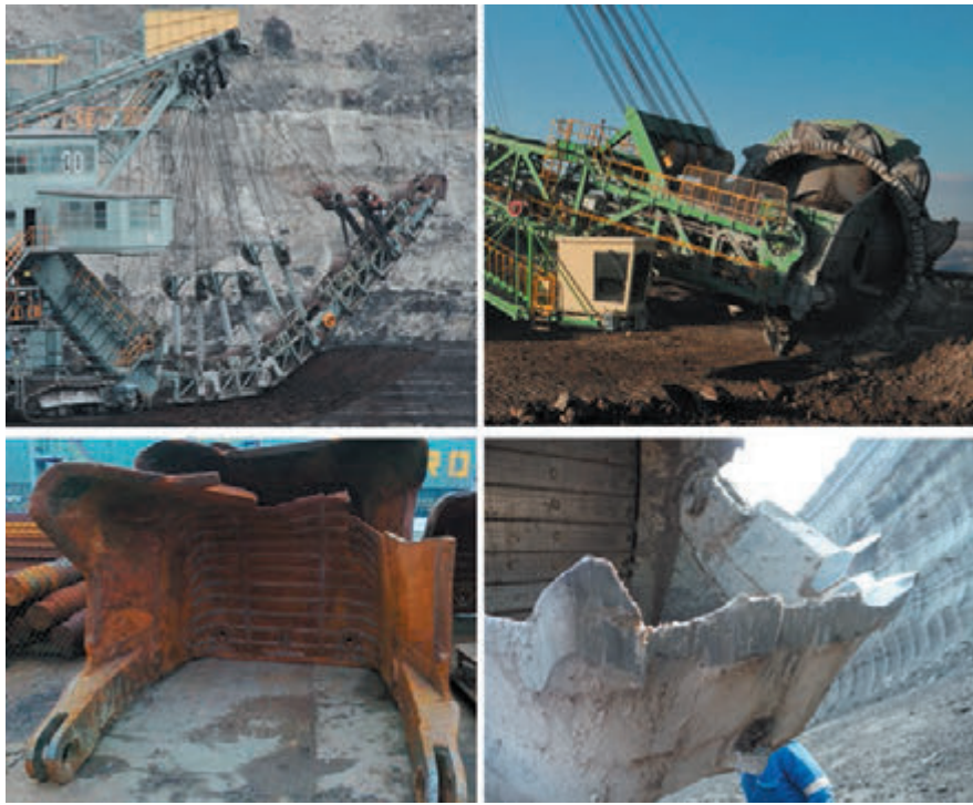
Rys. 1. Układy urabiania koparki łańcuchowej i kołowej oraz przykłady zużycia i uszkodzeń czerpaków
