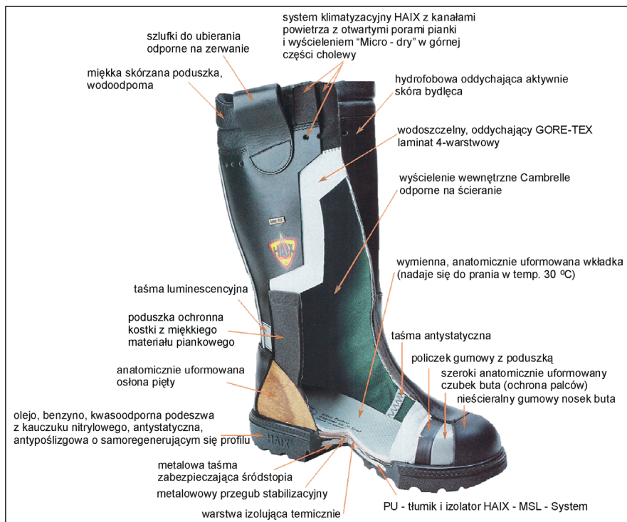
Rys.1. Buty strażackie, wiodącego producenta, w przekroju
