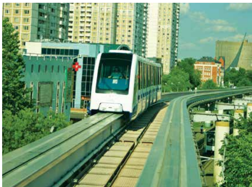
Zbudowana na podstawie technologii Siemens kolej magnetyczna wykorzystująca technologię EMS, Moskwa (18.06.2007 r.). Fot. P. Czech
