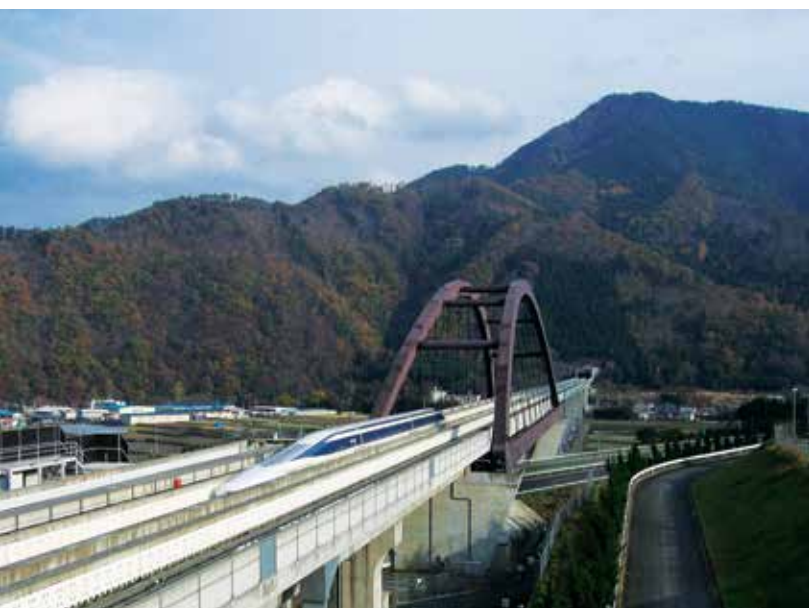
Pociąg Maglew serii MLX-01, wykorzystujący zjawisko EDS, odcinek testowy Yamanashi, Japonia (23.11.2005 r.). Fot. Yosemite
