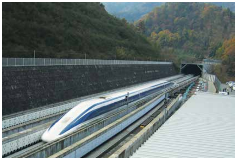
Pociąg Maglew serii MLX-01 wykorzystujący zjawisko EDS, odcinek testowy Yamanashi, Japonia (23.11.2005 r.). Fot. Yosemite
