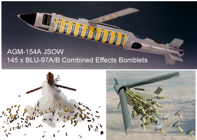
Rys. 3. Bomba AGM-154A podczas rozrzutu ładunków oraz bomba małego wagomiaru BLU-97/B złożona i z rozłożonym spadochronem hamującym
