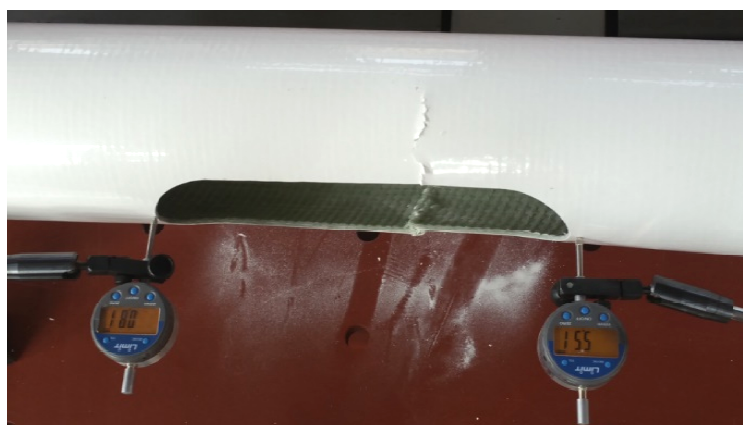
Rys. 2. Widok słupa w miejscu otworu rewizyjnego po badaniu niszczącym
