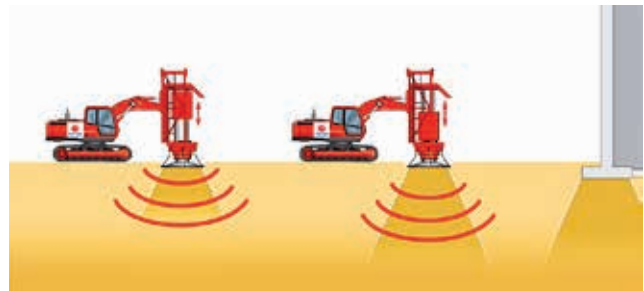
Ryc. 5. Technologia zagęszczenia impulsowego RIC [2]
