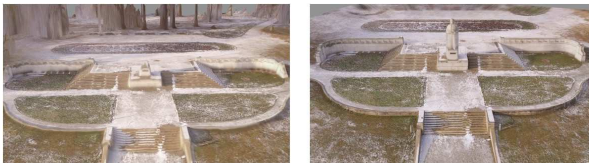
Rys. 14. Model 3D pomnika Adama Mickiewicza wykonany na podstawie nalotu autonomicznego (z lewej) oraz zdjęć uzyskanych za pomocą sterowania ręcznego (z prawej)
