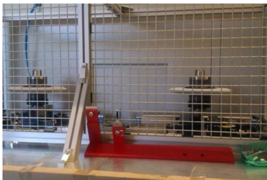
Rys. 17. Widok zmienarki ściernic szlifierki profilowej typu 1200 TITAN firmy Gleason - Pfauter
