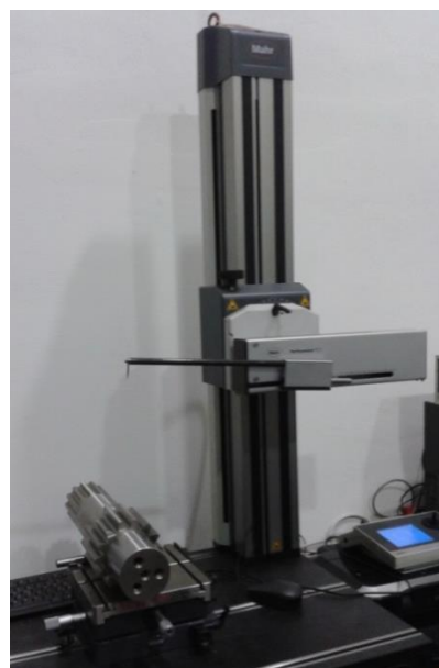
Rys. 9. Chropowatościomierz typu MarWin firmy MAHR
