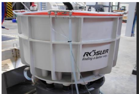
Rys. 18. Urządzenie do superfinishingu kół zębatych do średnicy 800 mm.
