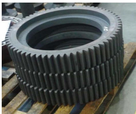
Rys. 8. Widok kół zębatach po procesie nawęglania
