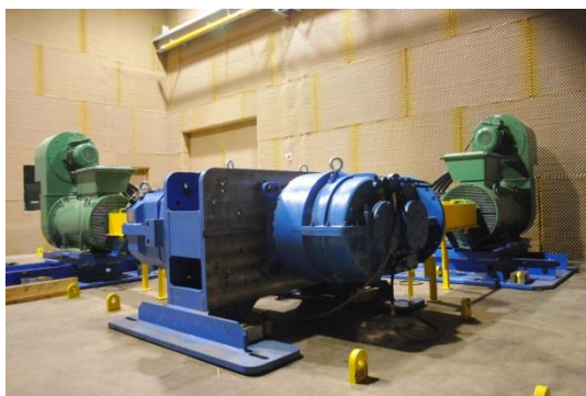
Rys. 19. Widok przekładni zębatych w trakcie testów na stacji prób.
