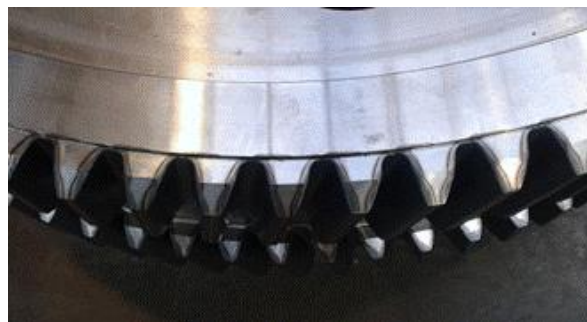
Rys.4 Widok uzębienia kół zębatych poddanych hartowaniu powierzchniowemu.
