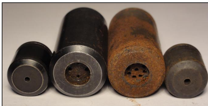
Fot. 3. Porównanie komory po wieloletnim stosowaniu (prawa) i nowej (lewa). Widoczne wżery od gazów prochowych przedostających się pomiędzy przednią płaszczyzną komory a lufą
