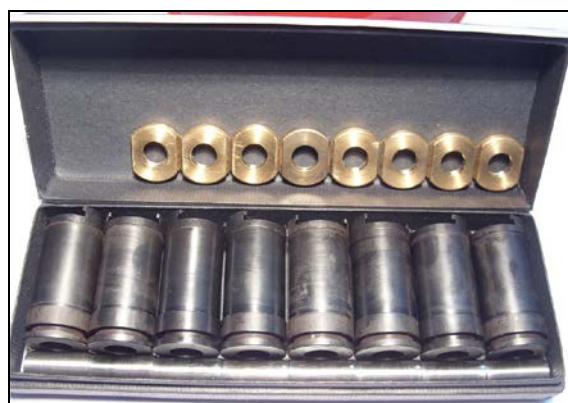
Fot. 5. Komory (4 typy po 2 szt.), uszczelniacze (2 typy po 4 szt.) i ograniczniki (2 typy po 4 szt.)
