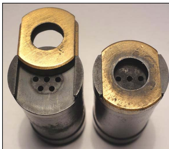
Fot. 6. Widok czola komór z 3 i 7 otworami z uszczelniaczami
