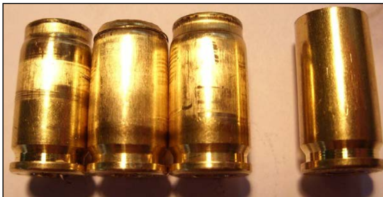
Fot. 7. Łuski odkształcone podczas ryglowania lufy. Po prawej łuska nowa
