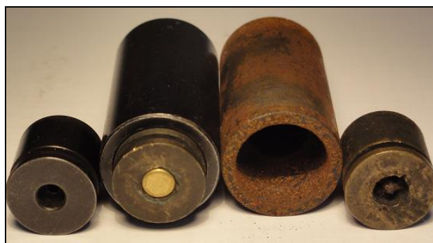
Fot. 2. Po prawej komora wysokiego ciśnienia i gniazdo spłonki po wieloletniej eksploatacji. Wyraźnie widoczne wypalania obrzeży i kowadełek powstałe na skutek wypływu gazów prochowych po obwodzie spłonki. Po lewej elementy nowe
