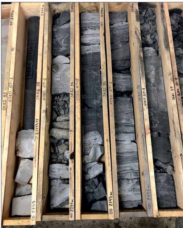
Ryc. 4. Rdzeń wiertniczy z poziomu wodonośnego kredy dolnej ujętego otworem Koło GT-1. Fot. I. Gryszkiewicz Fig. 4. Drill core from the Lower Cretaceous aquifer in the Koło GT-1 borehole. Photo by I. Gryszkiewicz
