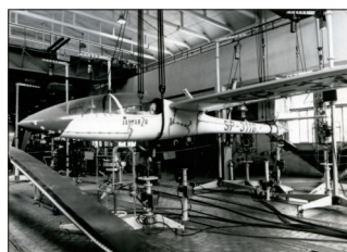
Fot. 15. Próby rezonansowe szybowca
