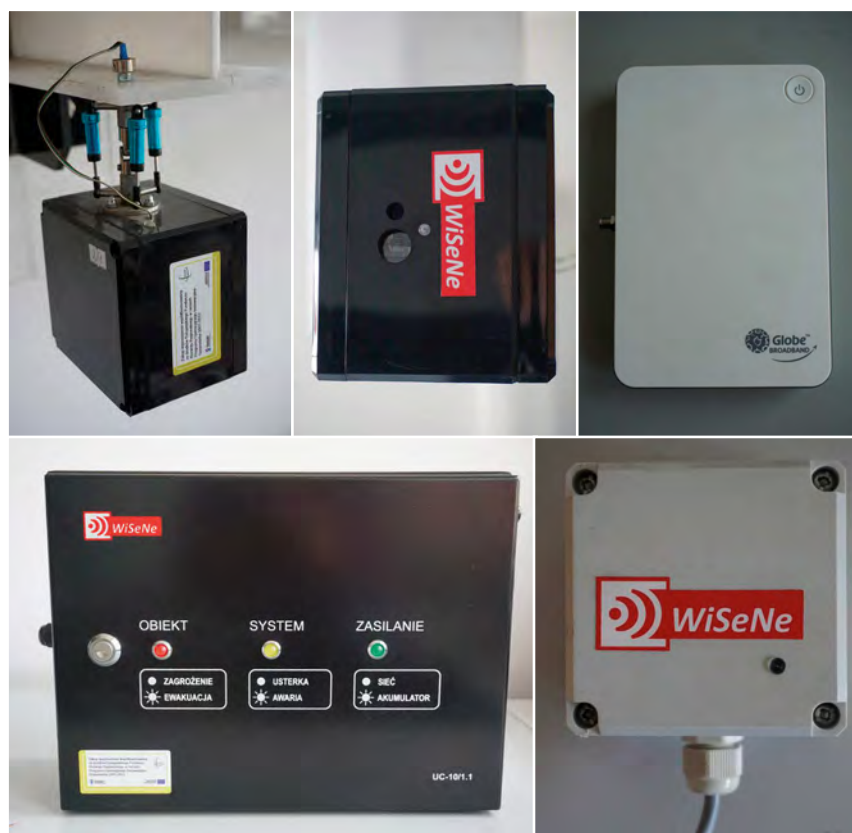
Rys. 1. Urządzenia systemu WiSeNe®: a) miernik laserowy – widok z góry; b) miernik laserowy – widok z dołu; c) urządzenie retransmisyjne; d) centrala; e) transceiver
