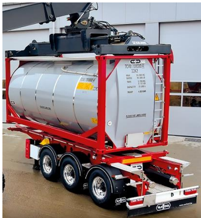
Rys. 2. Chemiczne zbiorniki transportowe ze stali nierdzewnej Duplex - Industeel UR™ 2205 [29]
