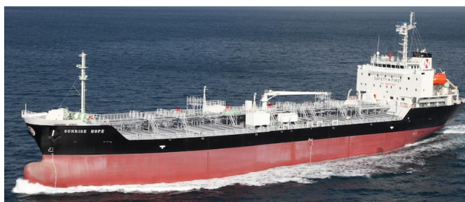
Rys. 1. Japoński chemikaliowiec ze stalowymi zbiornikami ładunkowymi zbudowanymi ze stali nierdzewnej Duplex [28]
