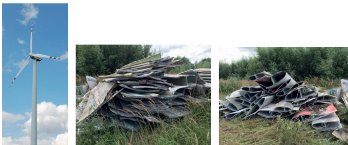
Rys. 6. Poddawane recyklingowi łopaty elektrowni wiatrowych [20] Fig. 6. Recycling of propeller blades from wind power plants [20]
