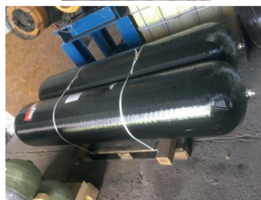
Rys. 1. Poddawane recyklingowi zbiorniki nawijane [20]
