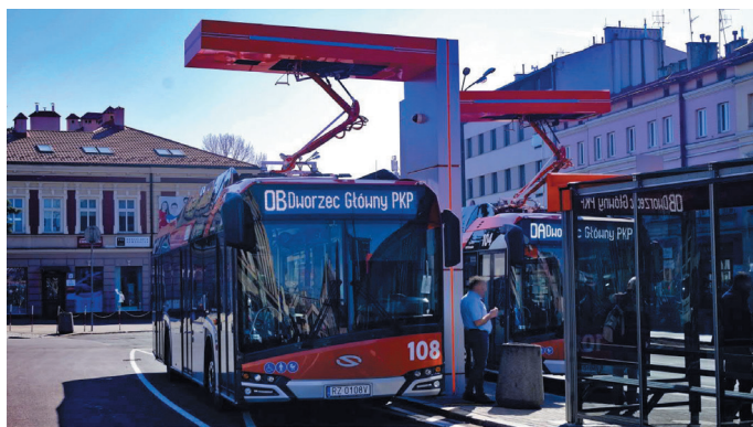
Fot. 3. Autobusy elektryczne doładowywane przy dworcu kolejowym w Rzeszowie. Fot. autor.
