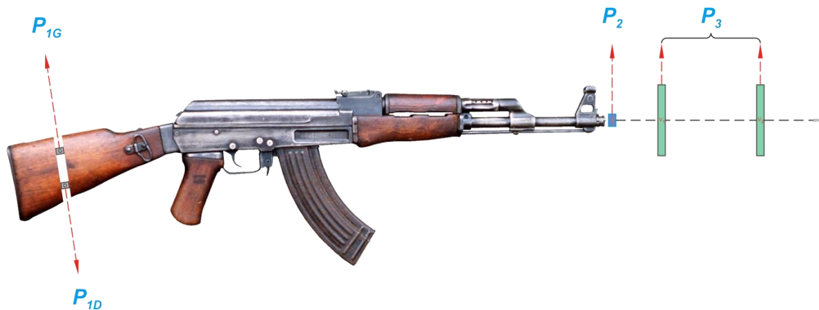
Rys. 3. Uproszczony schemat stanowiska pomiarowego dla wybranych parametrów w procesie strzału układu broń-strzelec: P_{1G} , P_{1D} – pomiar sił w kolbie [N], P_2 – pomiar czasu wyjścia pocisku z lufy [ms], P_3 – pomiar prędkości wylotowej [m/s].
