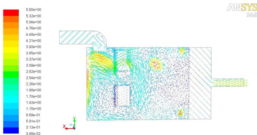
Rys.9. Rozkład wektorów prędkości w przekroju dla przypadku T_{out} = -20^{\circ}\text{C} , T_{in} = +4^{\circ}\text{C} przy działającym górnym parowaczu.
