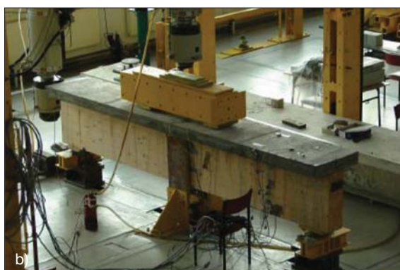
Fot. 6. Badanie: a) zespolenia drewna z betonem, b) belki zespolonej drewno-betonowej
