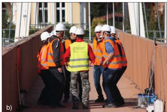
Fot. 4. Badania odbiorcze kładki w Przemysłu pod obciążeniem dynamicznym: a) przejście grupy 80 osób, b) synchroniczne podskoki
