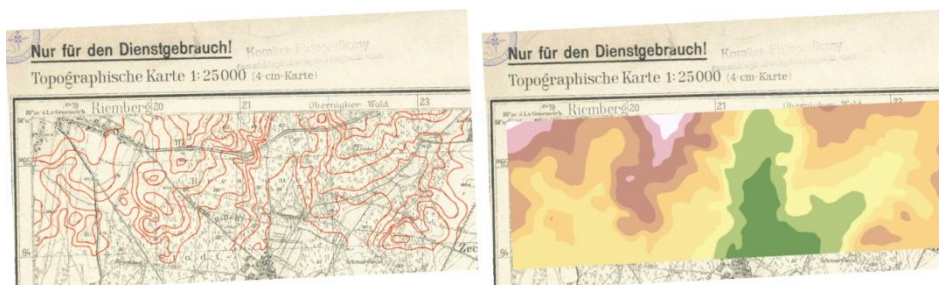
Rys. 2. Sposób tworzenia NMT na podstawie map Mastischblatt Fig. 2. Method of creating DTM based on the Mastischblatt maps
