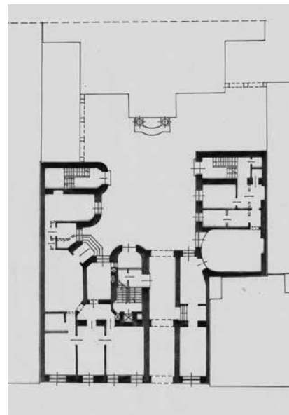
Il. 13. Plan parteru kamienicy przy ul. Lwowskiej 13. Rysunek wg pomiaru Miejskiego Biura Projektowego „Warcent” z lat 80. XX w.; źródło: Ryńska E.D., Architektoniczne i ekonomiczno-organizacyjne problemy przekształceń śródmiejskiej zabudowy mieszkaniowej na przykładzie kwartału ul. Lwowska, Koszykowa, Noakowskiego. Praca doktorska, 1993, mps. w zbiorach prywatnych
