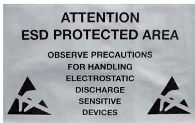
Rys. 4. Prawidłowe oznaczenie strefy EPA Fig. 4. Correct marking EPA
