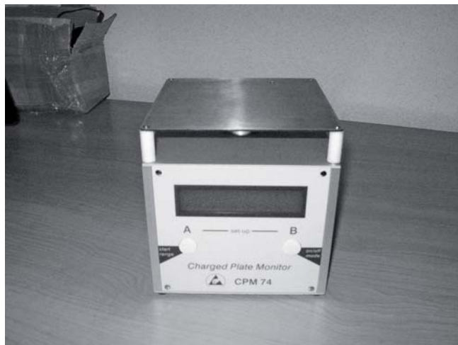
Rys. 10a. Monitor ładunku płyty CPM Fig. 10a. Charged Plate Monitor CPM
