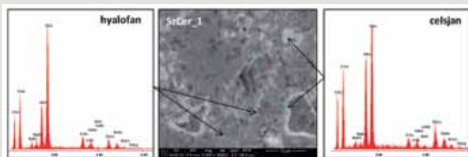
Rys. 6. Obrazy SEM-EDS tworzywa SzCer_1 wypalonego w temperaturze 1190 °C.
