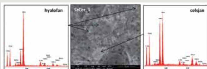
Rys. 8. Obrazy SEM-EDS tworzywa SzCer_1 wypalonego w temperaturze 1210 °C.
