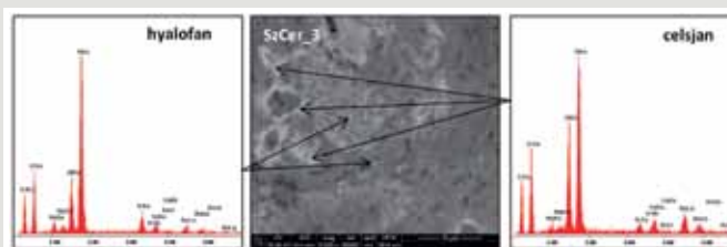
Rys. 12. Obrazy SEM-EDS tworzywa SzCer_3 wypalonego w temperaturze 1190 °C.
