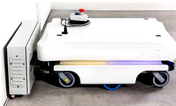
Rys. 5. Punkt automatycznego ładowania mobilnego robota do transportu firmy MIR [6]
