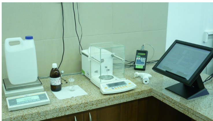
Rys. 2. Stanowisko do sporządzania wzorca ciekłego
