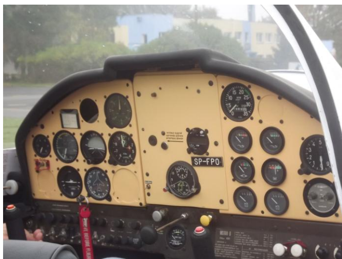
Rys. 2. Pulpit sterowniczy z wskaźnikami analogowymi samolotu Morane MS 880 B
