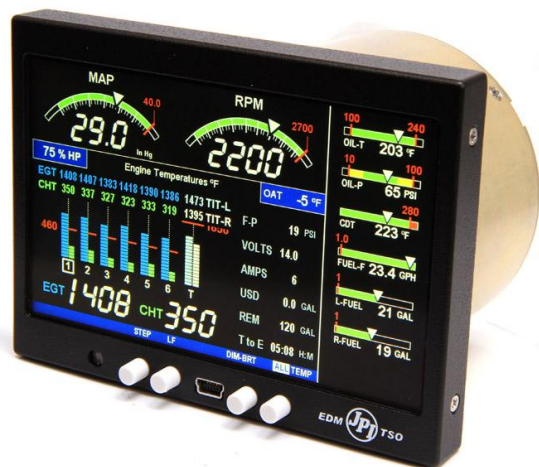
Rys. 3. Cyfrowy wskaźnik parametrów pracy silnika lotniczego JPI EDM-900 [5]
