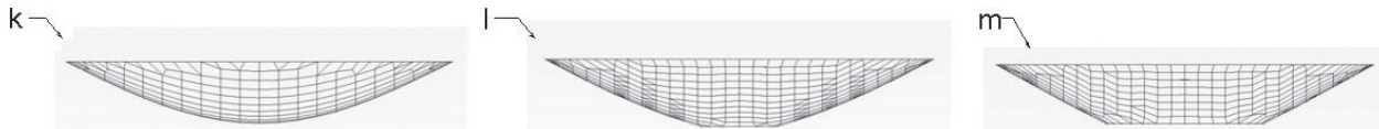
Il. 3. Widok boczny deformacji płyty bez otworu (k), z małym otworem (l) oraz z dużym otworem (m). Gdy skoreluje się deformacje z krzyżami momentów głównych z ilustracji 2, zauważy się, że krzywizna południkowa jest tym większa, im większe są momenty główne – południkowe. Ponieważ otwór zakłóca pracę układów południkowych, obserwuje się wypłaszczenie pasm południkowych w płytach z otworem (rys. autora)
