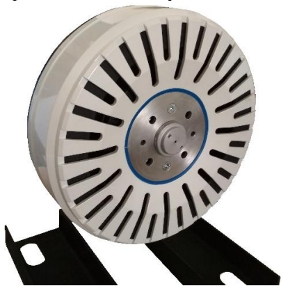
Rys. 1. Wykonany prototyp silnika do zabudowy w kole
