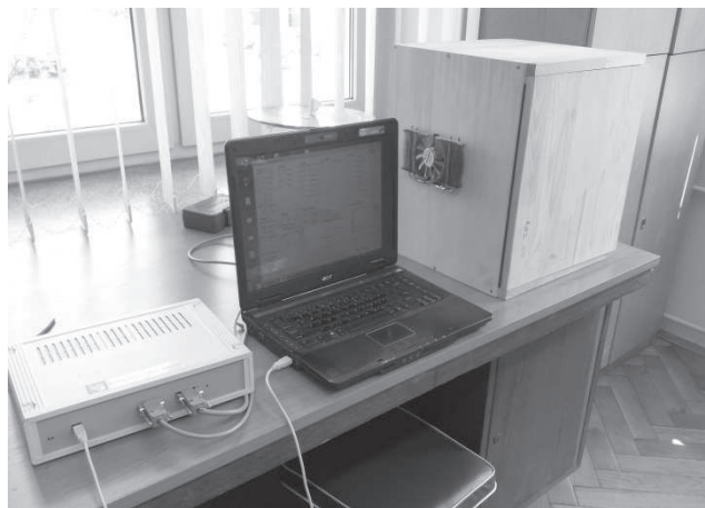
Rys. 2. System do stabilizacji temperatury w komorze pomiarowej
