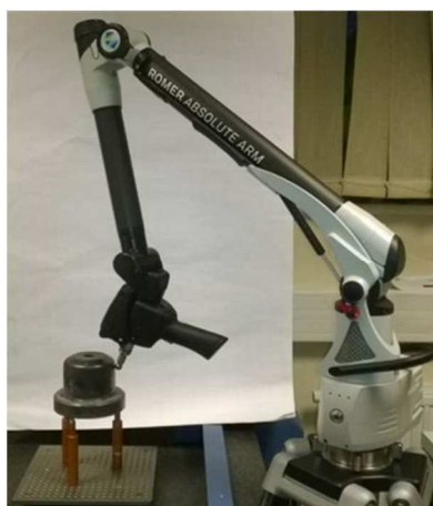
Rys. 1. Stanowisko do pomiarów z ramieniem pomiarowym ROMER Absolute Arm 7520si ze zintegrowanym skanerem laserowym RS3 do pomiarów matryc i odkuwek
