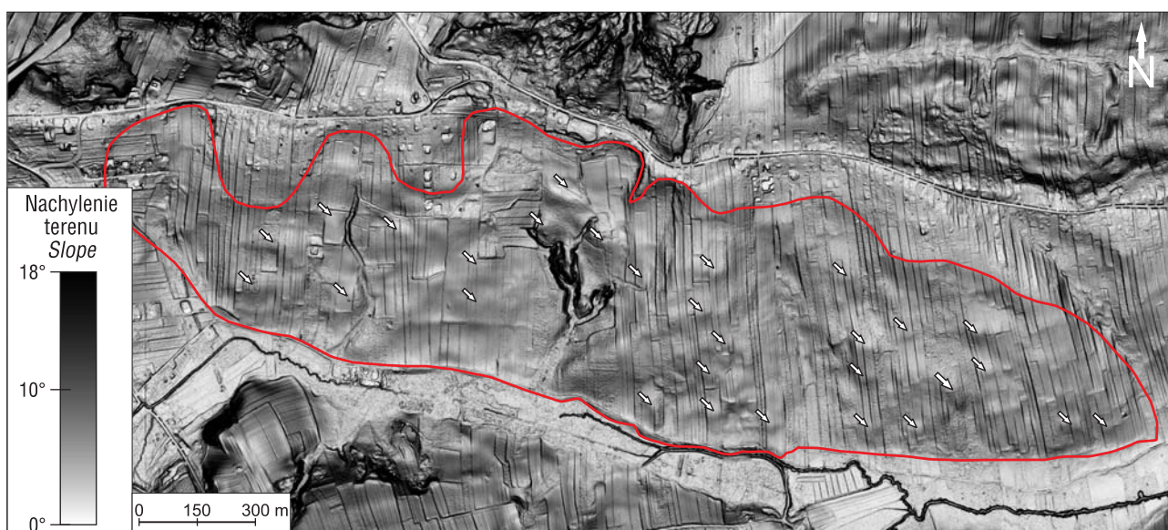
Ryc. 9. Osuwisko w Brzeźnicy na NMT. Białe strzałki wskazują wybrane kolisty nabrzmienia terenu (tj. muldy) Fig. 9. Landslide in Brzeźnica on the digital terrain model. White arrows showing circular terrain convexity
