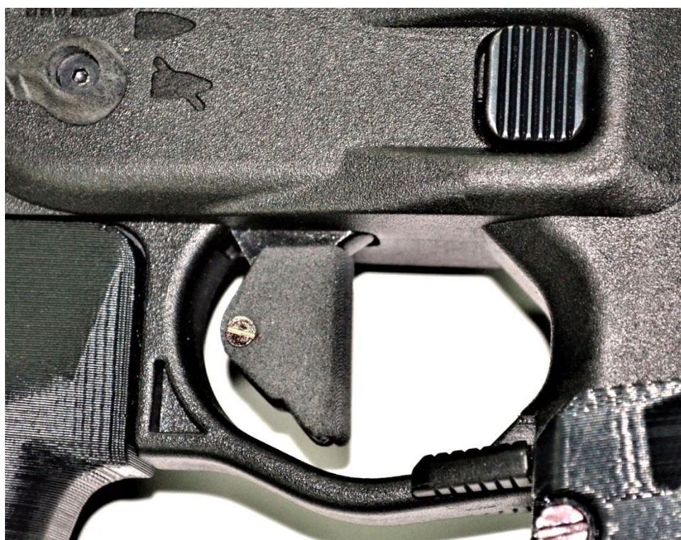
Fot. 7. Nakładka na język spustowy z płaską przednią ścianą Photo 7. Trigger adapter with a flat front profile
