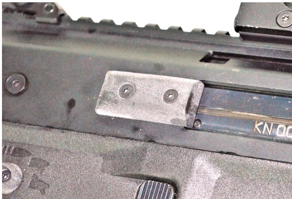
Fot. 4. Zmodyfikowany odbijacz łusek z występem wchodzącym w okno wyrzutowe Photo 4. Modified case deflector with a protrusion entering the ejection window
