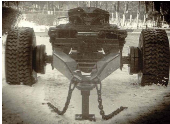
Рис. 1. Универсальная активная поворотная тележка прицепа с возможностью сдваивания колес и варианты средств ее агрегатирования
