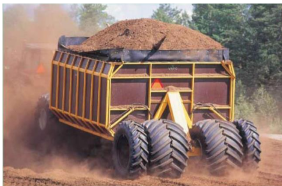
Рис. 4. Схема и вид большегрузного прицепа для перевозки грузов малой плотности Fig. 4. The scheme and picture of large capacity trailer
