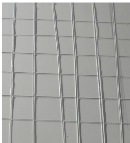
Rys.4. Przykładowy obraz rezultatów badania przyczepności powłoki malarskiej
