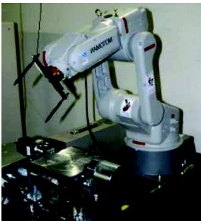
Rys. 2. Robot z narzędziem do cięcia styropianu współpracujący ze stołem obrotowo-uchylnym [16]
