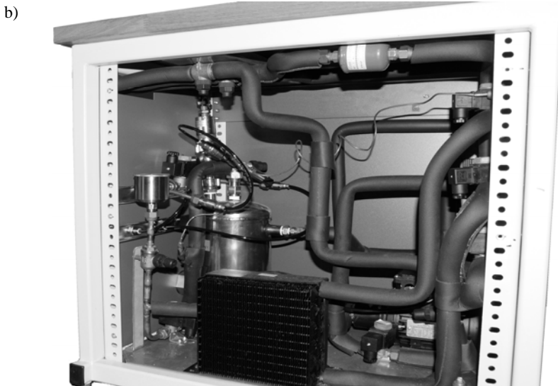
Rys. 5. Układ dystrybucji czynnika niskowrzącego: a) schemat funkcjonalny, b) widok układu (ustawienie poziome) Fig. 5. Distribution system of heat transfer engineer fluid: a) draft, b) system view (description in the text)
