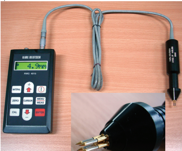
Rys. 4. Sonda potencjałowa RMG 4015; a) widok ogólny, b) głowica do pomiaru pęknięć prostopadłych do badanej powierzchni [fot. W. Sawczuk]
