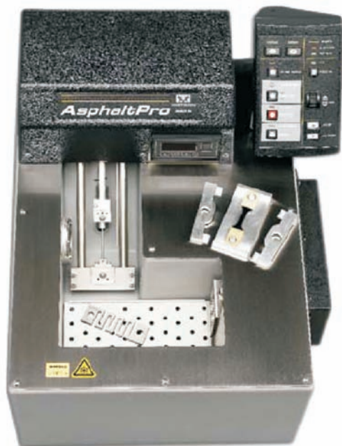
Rys. 4. Urządzenie pomiarowe do badania wydłużenia według PN-EN 13587 [3]
