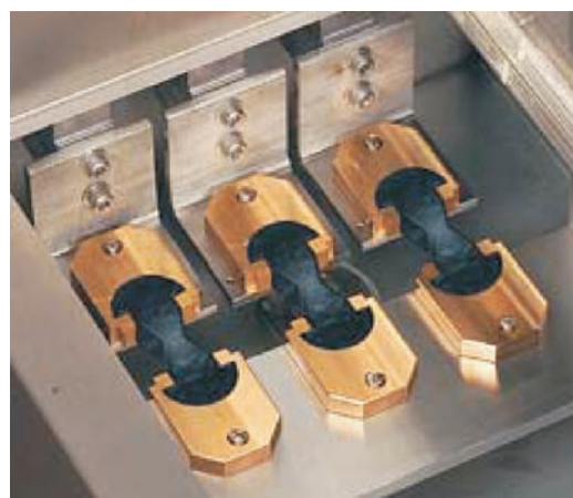
Rys. 3. Sposób zamocowania próbek w duktylometrze [4]
