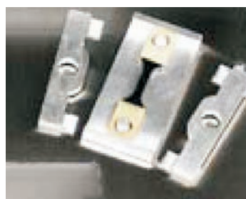
Rys. 5. Kształt próbek asfaltu do badania rozciągania według PN-EN 13587 [3]
