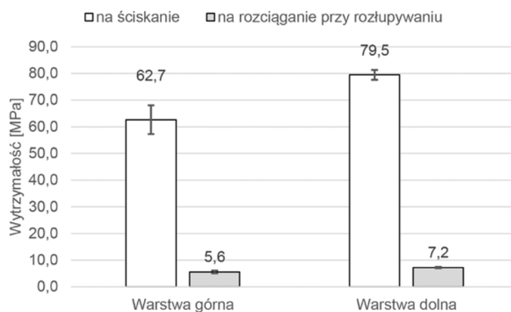
Rys. 1. Wyniki badań wytrzymałości badanego betonu na ściskanie i rozciąganie z zaznaczonym odchyleniem standardowym
