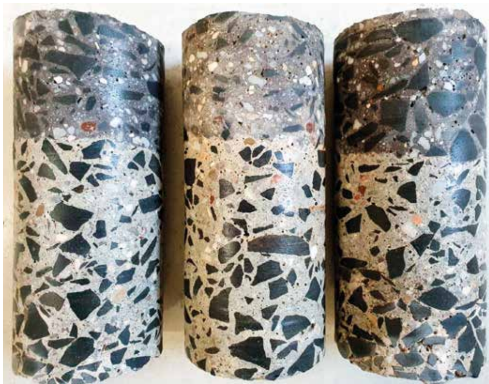
Fot. 1. Widok odwiertów pobranych z nawierzchni
