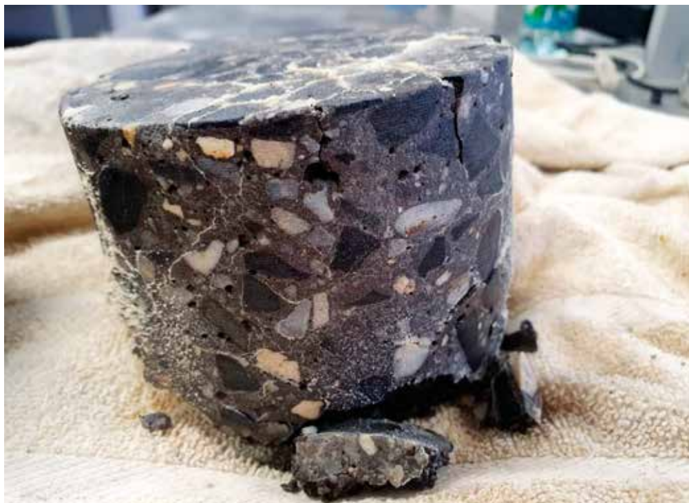
Fot. 2. Widok próbki betonu z górnej warstwy nawierzchni autostrady po 100 cyklach zamrażania i rozmrażania
