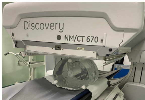
Ryc. 1 Ułożenie fantomu podczas wykonywania pomiarów na gamma kamerze Discovery NM/CT 670. Źródło: Materiał własny.
