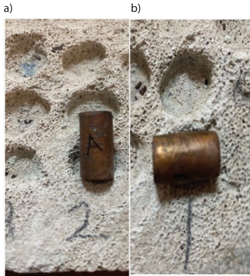
Photo 1. Image of sample: a) before corrosion test, b) after corrosion test Fot. 1. Obraz próbki: a) przed badaniem korozyjnym, b) po badaniu korozyjnym
