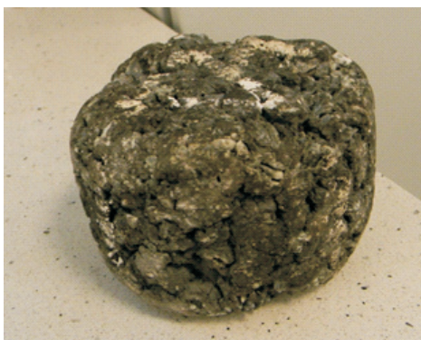
Rys. 3.3. Ubytek ziaren — próbka po teście Cantabro
