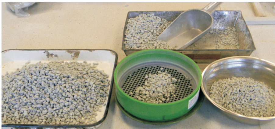
Rys. 3.6. Przesiew gąbrosz 4/8 w celu uzyskania uziarnienia 5/8 do mieszanki PA 8
