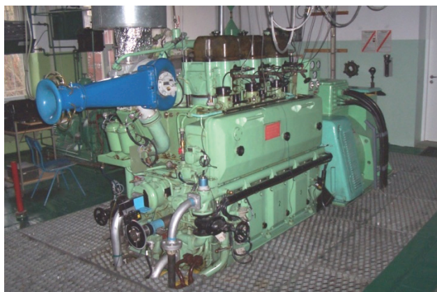
Rys. 1. Widok ogólny silnika Sulzer 3 AL 25/30
